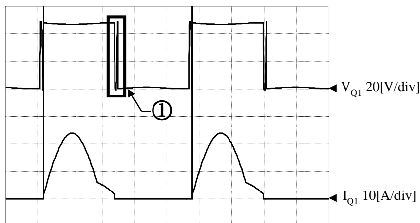
図 20 ピーク周波数時の各部シミュレーション波形(Mode 4 動作時に励磁電流がすべて転流)
