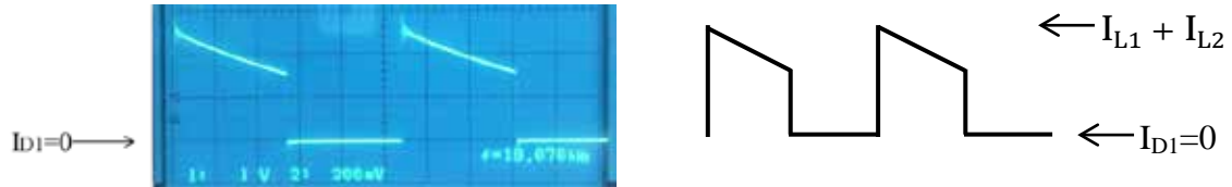
図 3.1.17 I_{D1} の実測波形と理論波形の比較
