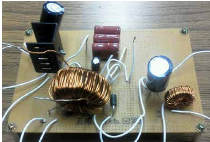
図 A2 同一鉄心 Zeta コンバータの回路
