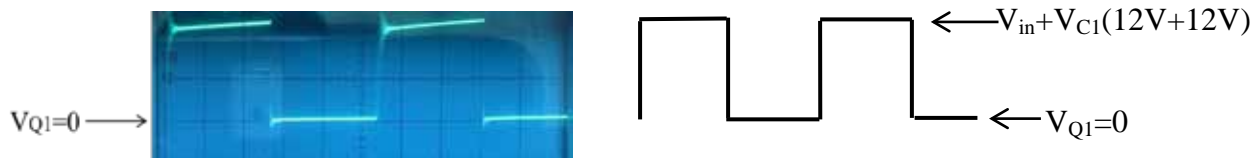
図 3.1.12 V_{Q1} の実測波形と理論波形の比較
