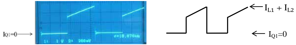
図 3.1.16 I_{Q1} の実測波形と理論波形の比較
